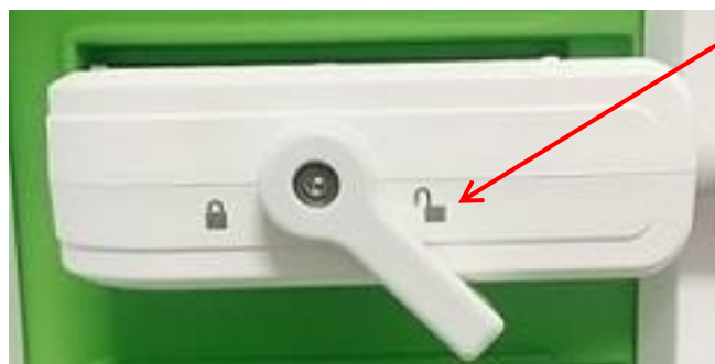
図11：ロック解除したトランスデューサコネクタロックつまみ
